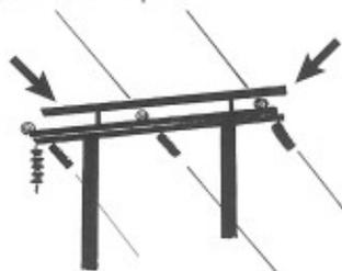
Figure 1: Structure d'invalidation (barre trop étroite pour la nidification et empêchant l'accès aux barres transversales).
